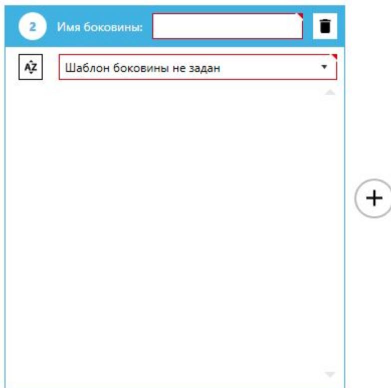
Далее боковине следует задать имя (будет отображаться в итоговом отчете над заголовком таблицы), а также шаблон, который определяет сторону внешних подключений.
