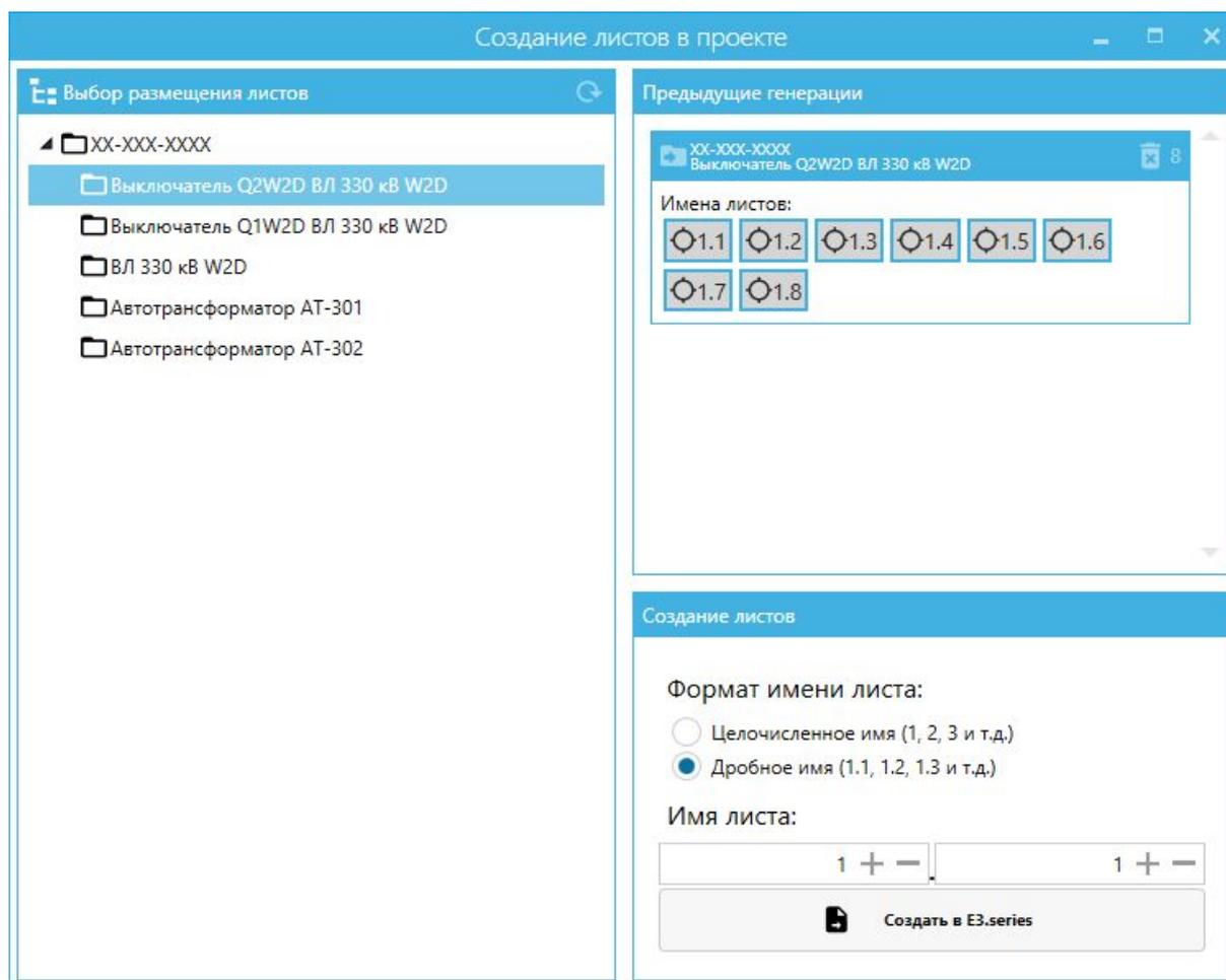
В этом окне пользователь может задать раздел структурного дерева E3.series, где будут размещены итоговые листы, и задать им имя. Дополнительно отображается список предыдущих генераций отчетов для клеммников в обработке.
